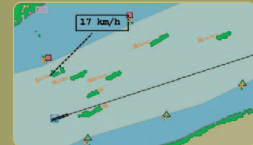
Rekonstruktion kritischer Verkehrssituationen durch Aufnahmefunktion | Reconstructie van een gevaarlijke verkeerssituatie met de opnamefunctie | Recording option allows reconstruction of critical traffic situations | Reconstitution de situations de circulation critiques par le biais de la fonction d'enregistrement
