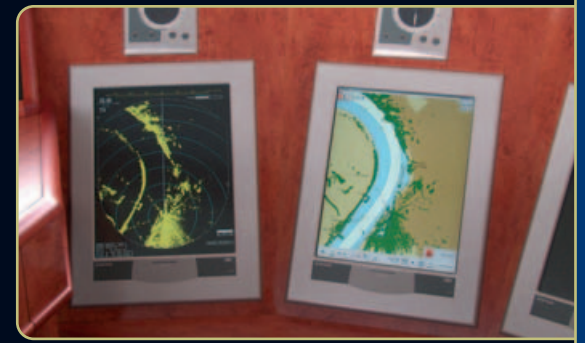
Radarbild und Display von RADARpilot720° im Steuerstand | Radarbeeld en display van RADARpilot720° in de stuurhut | Radar display and RADARpilot720° in the helmstand | Image radar et affichage de RADARpilot720° dans le gouvernail
